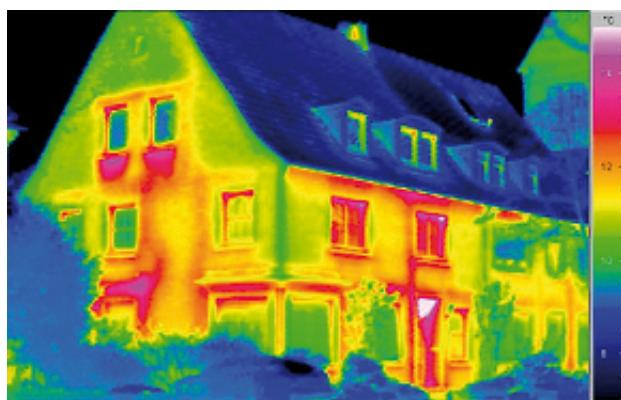
Um Wärmeverluste darzustellen bedient man sich der Möglichkeit, mit einem bildgebenden Verfahren, Infrarotstrahlung sichtbar zu machen.
