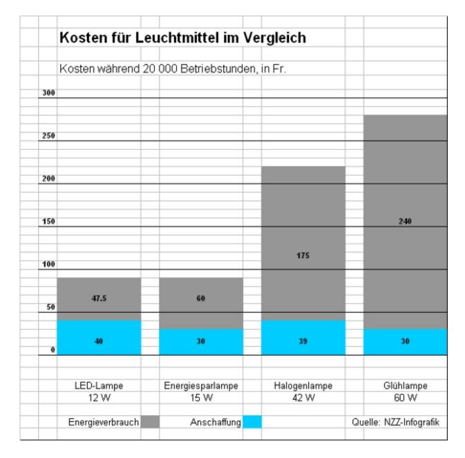
Auf Grund der unterschiedlichen Wirkungsgrade von Leuchtmitteln ist es unmöglich, diese nur anhand ihrer Leistung (Einheit in Watt) zu vergleichen. Legt man die abgestrahlte Lichtmenge (Einheit in Lumen) zugrunde, wird es etwas einfacher.
