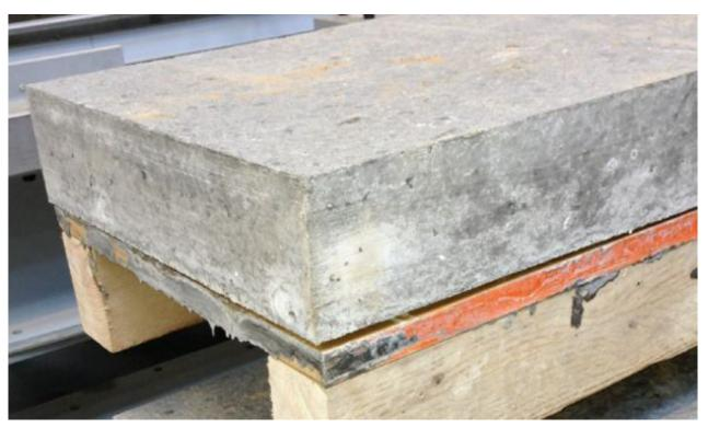
Holzbeton verbindet die Vorteile von Beton und Holz.
