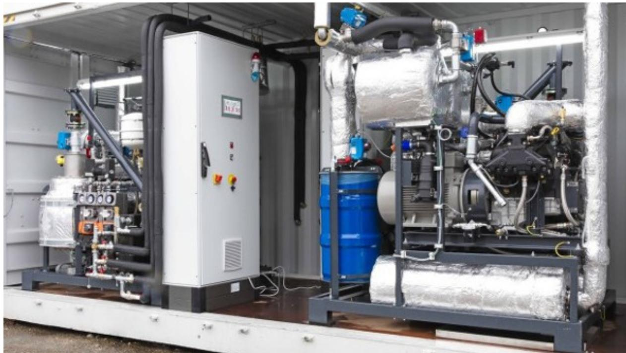
Statt des Gas- oder Dieselmotors im Kleinkraftwerk, liefert der weiter entwickelte Holzvergaser auf minimaler Grundfläche eine beachtliche Leistung ab. Das Kraftpaket ist in der Lage aus Biomasse 25 kWh Strom und 60 kWh Wärme zu produzieren. Die Kraft-Wärme-Kopplung ist ideal für eine Nahwärme- und Stromversorgung in landwirtschaftlichen Betrieben, Hotels, Mehrfamilienhäusern oder als Insellösung in Entwicklungsländern.
