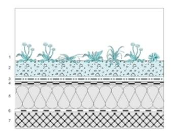
**intensive Begrünung: 1** Bepflanzung, 2 Vegetationsschicht, 3 Speichermatte, 4 Drain- und Schutzmatte, 5 Abdichtung, 6 Wärmedämmung, 7 Dampfbremse, 8 Betondecke
