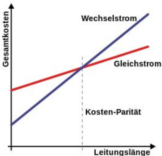
Eine zuverlässige Versorgung mit Strom aus erneuerbaren Quellen macht neue Stromautobahnen notwendig, denn nicht immer wird er dort verbraucht, wo er auch erzeugt wird. Strom aus Windkraft z.B. muss von den Küsten oft zu den Industriezentren im Landesinneren gebracht werden. Werden die Trassen sehr lange, geht viel Strom auf dem Übertragungsweg verloren. Daher macht es Sinn ab bestimmten Leitungslängen von der Wechselstromübertragung auf Gleichstromkabel umzustellen.
