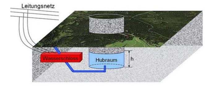
Wissen und Gerät dazu sind vorhanden. Aus massivem Granitgestein wird ein Zylinder mit einem Durchmesser von einem Kilometer herausgesägt. Die Wandung wird abgedichtet und über ein Wasserschloss wird Wasser mit überschüssiger elektrischer Energie unter den Zylinder gepumpt, der sich dadurch anhebt. So könnte in einer Anlage dieser Grössenordnung die Tagesleistung der gesamten
