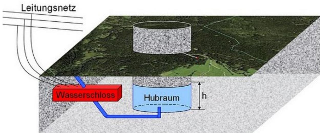
Wissen und Gerät dazu sind vorhanden. Aus massivem Granitgestein wird ein Zylinder mit einem Durchmesser von einem Kilometer herausgesägt. Die Wandung wird abgedichtet und über ein Wasserschloss wird Wasser mit überschüssiger elektrischer Energie unter den Zylinder gepumpt, der sich dadurch anhebt. So könnte in einer Anlage dieser Größenordnung die Tagesleistung der gesamten
