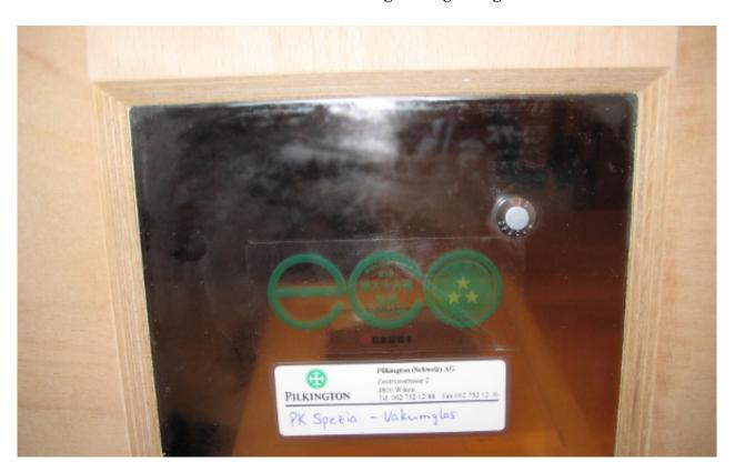
Heute übliche Verglasungen erreichen einen U-Wert von 0,7 W/m2K. Neue Entwicklungen sind sogar noch besser. Trotzdem ist ein Fenster immer noch das am schlechtesten gedämmte Bauteil der Gebäudehülle. Um diese Schwachstelle auszumerzen, bemühen sich weltweit Forschungseinrichtungen und Fensterhersteller um das Vakuumfenster. Diese Art Fenster könnte die Wärmedämmung der Gebäudehülle revolutionieren, da trotz aller Fortschritte das Fenster noch das schwächste Dämmglied ist.
