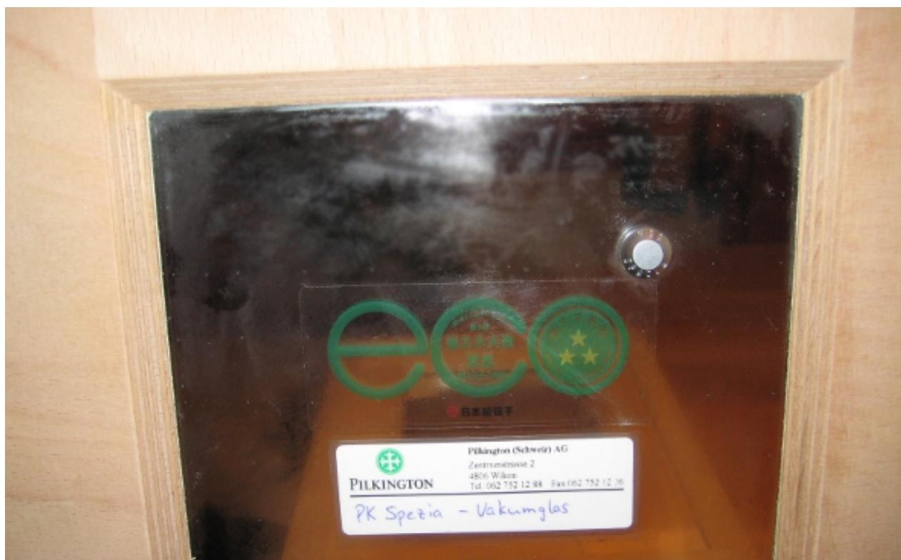
Heute übliche Verglasungen erreichen einen U-Wert von 0,7 W/m<sup>2</sup>K. Neue Entwicklungen sind sogar noch besser. Trotzdem ist ein Fenster immer noch das am schlechtesten gedämmte Bauteil der Gebäudehülle. Um diese Schwachstelle auszumerzen, bemühen sich weltweit Forschungseinrichtungen und Fensterhersteller um das Vakuumfenster. Diese Art Fenster könnte die Wärmedämmung der Gebäudehülle revolutionieren, da trotz aller Fortschritte das Fenster noch das schwächste Dämmglied ist.
