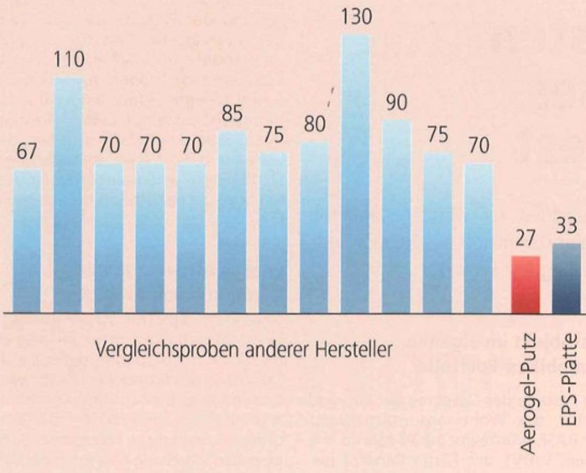
Vergleich von aktuellen Dämmputzen mit dem neu entwickelten Aerogel-Putz: Das Material isoliert vergleichbar gut wie eine EPS-Platte (EPS = Extrudiertes Polystyrol). (Bild: Empa)
