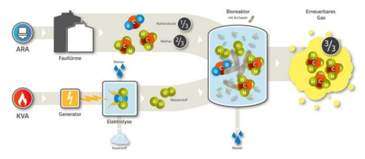
Das Schema zeigt, wie die Power-to-Gas-Technologie funktioniert. © Limeco
