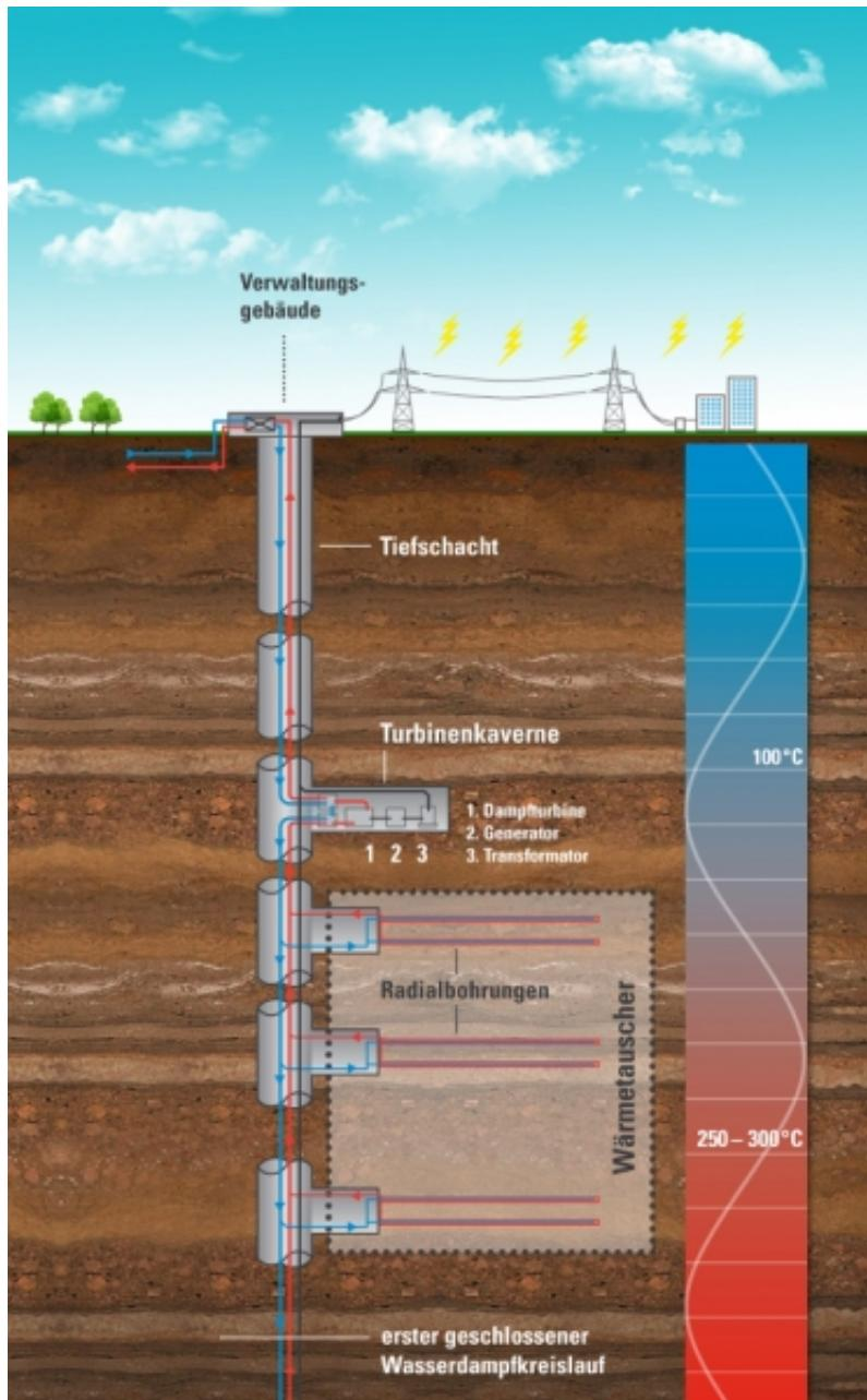
Während Geothermiekraftwerke schon länger weltweit im Einsatz sind, kommt eine neue Idee aus der Ostschweiz. Nicht „Nadelstiche“ in die Erdkruste bohren, die oft nur auf Gutglück die erforderliche Wärme aus Störzonen für den Betrieb liefern, sondern ein richtig tiefes Loch. Ein Tunnel, senkrecht in die Tiefe, 6 000 bis 10 000 Meter, mit 12 Metern im Durchmesser soll es sein, wenn es nach den Vorstellungen der DTE-Engeneering (Deep Thermal Energie) aus Weinfelden geht.
