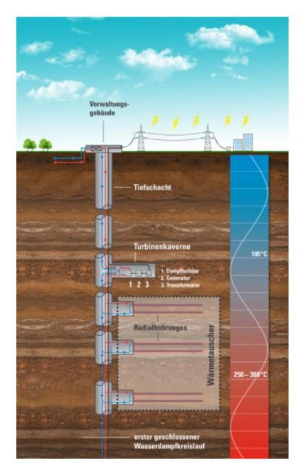
Während Geothermiekraftwerke schon länger weltweit im Einsatz sind, kommt eine neue Idee aus der Ostschweiz. Nicht "Nadelstiche" in die Erdkruste bohren, die oft nur auf Gutglück die erforderliche Wärme aus Störzonen für den Betrieb liefern, sondern ein richtig tiefes Loch. Ein Tunnel, senkrecht in die Tiefe, 6 000 bis 10 000 Meter, mit 12 Metern im Durchmesser soll es sein, wenn es nach den Vorstellungen der DTE-Engeneering (Deep Thermal Energie) aus Weinfelden geht.
