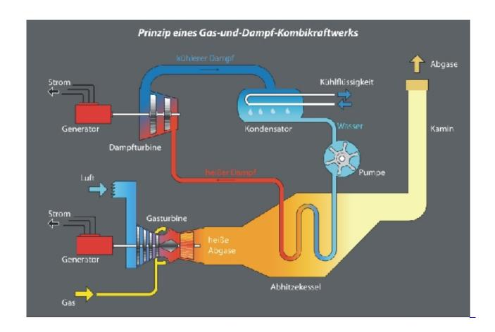
KONZEPT: Umbau der AKWs zu Gaskombikraftwerken mit grünem Wasserstoff-Gas- und bestehenden Dampfturbinen/Generator/Kühlturm (W-GuD) und Wasserstoffspeicherung und/oder Regionale/Lokale WärmeKraftKopplung (WKK) mit Abwärmenutzung
