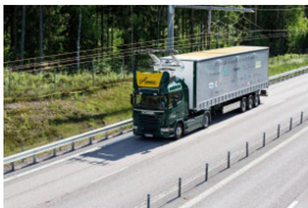
In Schweden findet der Test statt, wie gut Lastwagen mit Strom aus Oberleitungen fahren. Der eHighway auf dem Autobahnabschnitt nördlich von Stockholm beträgt zwei Kilometer. Er trägt zur Senkung des Energieverbrauches und der Luftverschmutzung durch den Güterverkehr auf der Strasse bei.
