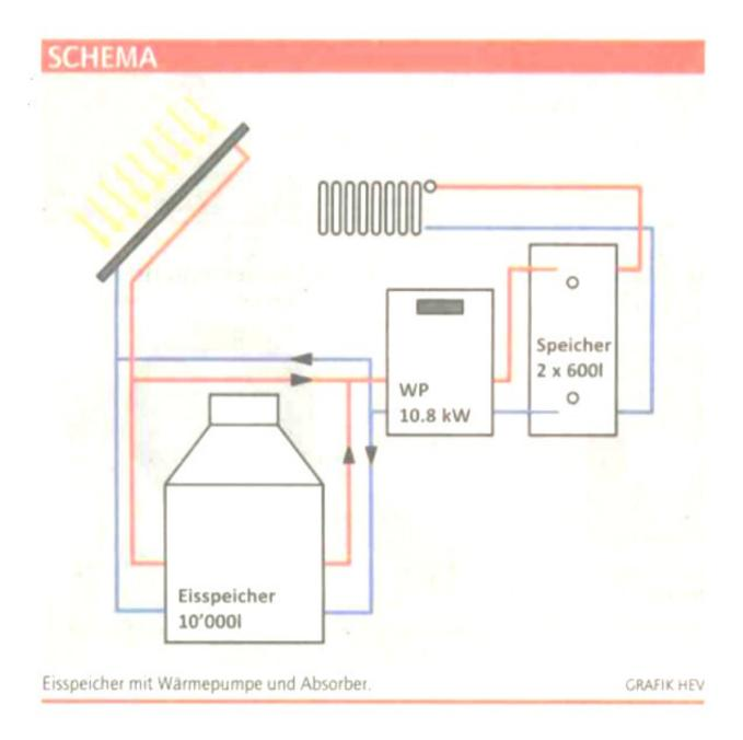
Um eine optimale Auslegung aller Komponenten zu erreichen, muss das Gebäude nicht nur gut gedämmt sein. Alle Systeme wie Sonnenkollektoren, Eisspeicher, Wärmepumpe und Pufferspeicher müssen optimal ausgelegt und exakt aufeinander abgestimmt werden.
