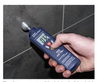
• Feuchtemessgeräte: Die richtige Luftfeuchtigkeit in Räumen und Bauteilen entscheidet darüber, ob wir uns wohl fühlen, krank werden oder ganze Bauteile Schaden nehmen.
