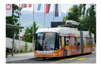
Eine Weltneuheit wir zurzeit in Genf getestet. Elektrobusse, die ohne Oberleitungen auskommen und innerhalb kürzester Zeit aufgeladen werden. Die auf dem Dach montierte Batterie wird an der Haltestelle, während die Fahrgäste aus- und einsteigen, aufgeladen. Benötigt werden dafür nur 15 Sekunden und der Strom stammt zu beinahe 100 Prozent aus erneuerbaren Quellen.
