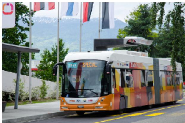
Eine Weltneuheit wird zurzeit in Genf getestet. Elektrobusse, die ohne Oberleitungen auskommen und innerhalb kürzester Zeit aufgeladen werden. Die auf dem Dach montierte Batterie wird an der Haltestelle, während die Fahrgäste aus- und einsteigen, aufgeladen. Benötigt werden dafür nur 15 Sekunden und der Strom stammt zu beinahe 100 Prozent aus erneuerbaren Quellen.
