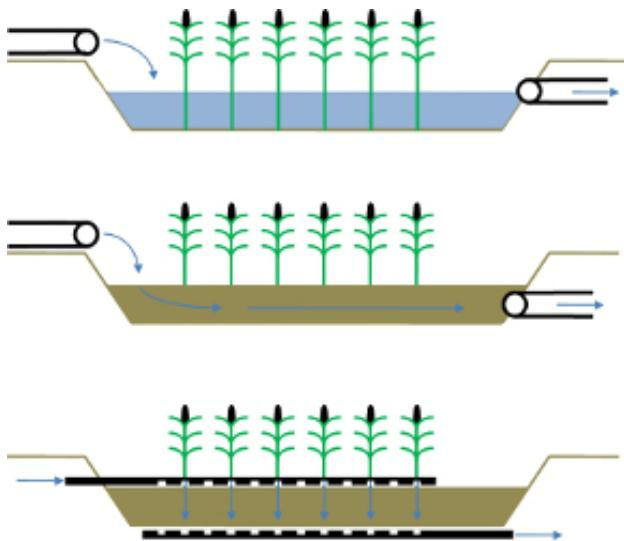
(von oben nach unten) Horizontal durchströmte Freiwasserpflanzenkläranlage, horizontal durchströmte Untergrundpflanzenkläranlage, vertikal durchströmte Untergrundpflanzenkläranlage
