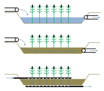
(von oben nach untern) Horizontal durchströmte Freiwasserpflanzenkläranlage, horizontal durchströmte Untergrundpflanzenkläranlage, vertikal durchströmte Untergrundpflanzenkläranlage
