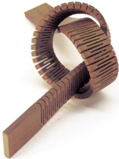
Geschwungene Formen im Holz- und Möbelbau waren bisher nur mit aufwändigen und teuren Verarbeitungstechniken möglich. Ein neues und relativ einfaches Verfahren ermöglicht es nun, dass die sonst steifen Holzwerkstoffplatten dreidimensional verformt werden können. Die hohe Flexibilität wird durch gegenläufige und regelmässige Einschnitte erreicht.
