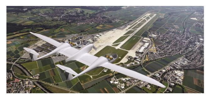
Das erste elektrische Passagierflugzeug der Welt wird durch einen Elektromotor angetrieben. Anstatt Kerosin benötigt es den Strom von <u>Brennstoffzellen</u>. Abgase und Lärm entstehen dabei nicht. Der Strom wird aus Wasserstoff und Luft hergestellt und es wird nur Wasserdampf ausgestossen.
