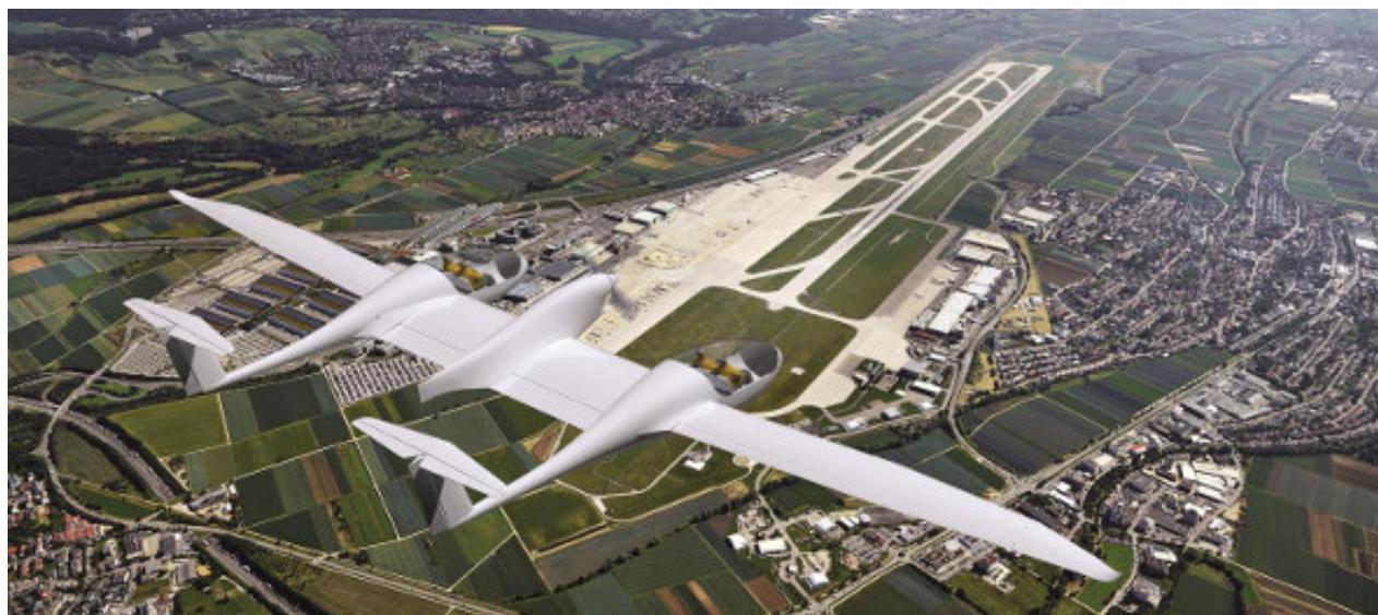
Das erste elektrische Passagierflugzeug der Welt wird durch einen Elektromotor angetrieben. Anstatt Kerosin benötigt es den Strom von [Brennstoffzellen](#). Abgase und Lärm entstehen dabei nicht. Der Strom wird aus Wasserstoff und Luft hergestellt und es wird nur Wasserdampf ausgestossen.
