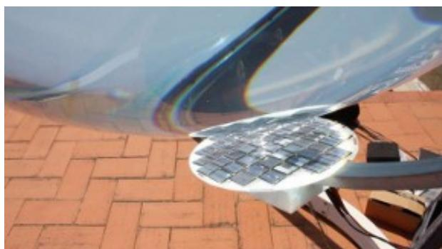
Um die Kraft der Sonne optimal zu nutzen, wurde schon öfter in die Trickkiste gegriffen. Neu ist, dass die mit Flüssigkeit gefüllten Glaskugeln das direkte und auch das diffuse Sonnenlicht konzentrieren und wie eine Lupe auf eine kleine Fläche projizieren. Die sich im Inneren befindliche Solarzelle wandert der sich im Glas spiegelnden Sonne nach.
