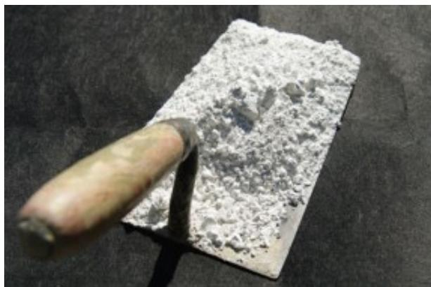
Hydraulischer Kalk ist wie Zement kein chemischer einheitlicher Stoff. Er ist zusammengesetzt aus verschiedenen Verbindungen des Calciums mit Silizium, Aluminium und Eisenoxiden. Das ausgesuchte Felsmaterial liefert die bestmögliche Zusammensetzung der Grundelemente. Der Hydraulische Kalk kann auch im Wasser, ohne Luftzutritt erhärten.
