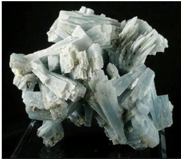
Anhydrit ist ein natürliches Material. Als Rohstoffe für die Herstellung dient der natürliche Anhydritstein. Dieser besteht aus kristallwasserfreiem Calciumsulfat und ist chemisch mit Gips verwandt. Man gewinnt Anhydrit durch Brennen bei hohen Temperaturen aus Gipsstein oder fällt als synthetischer Anhydrit in grossen Mengen bei der Flusssäure-Herstellung als Nebenprodukt an.
