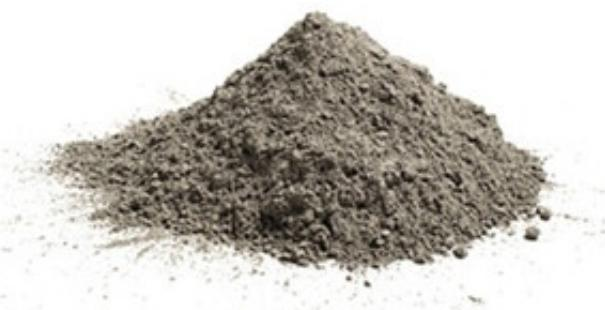
Zement ist ein hydraulisches Bindemittel, das heisst, ein fein gemahlener anorganischer Stoff, der mit Wasser gemischt, Zementleim ergibt. Nach dem Erstarren und Erhärten durch Hydratation bleibt er auch unter Wasser fest und raumbeständig.
