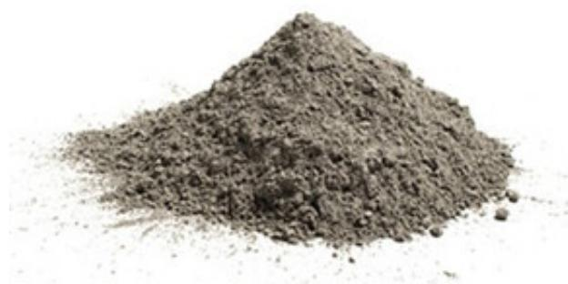
Zement ist ein hydraulisches Bindemittel, das heisst, ein fein gemahlener anorganischer Stoff, der mit Wasser gemischt, Zementleim ergibt. Nach dem Erstarren und Erhärten durch Hydratation bleibt er auch unter Wasser fest und raumbeständig.
