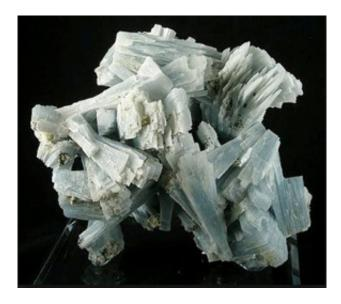
Anhydrit ist ein natürliches Material. Als Rohstoffe für die Herstellung dient der natürliche Anhydritstein. Dieser besteht aus kristallwasserfreiem Calciumsulfat und ist chemisch mit Gips verwandt. Man gewinnt Anhydrit durch Brennen bei hohen Temperaturen aus Gipsstein oder fällt als synthetischer Anhydrit in grossen Mengen bei der Flusssäure-Herstellung als Nebenprodukt an.
