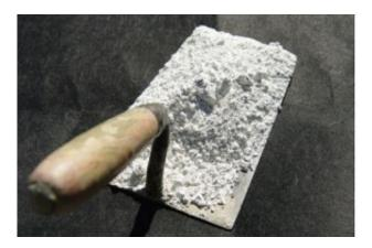
Hydraulischer Kalk ist wie Zement kein chemischer einheitlicher Stoff. Er ist zusammengesetzt aus verschiedenen Verbindungen des Calciums mit Silizium, Aluminium und Eisenoxiden. Das ausgesuchte Felsmaterial liefert die bestmögliche Zusammensetzung der Grundelemente. Der Hydraulischer Kalk kann auch im Wasser, ohne Luftzutritt erhärten.
