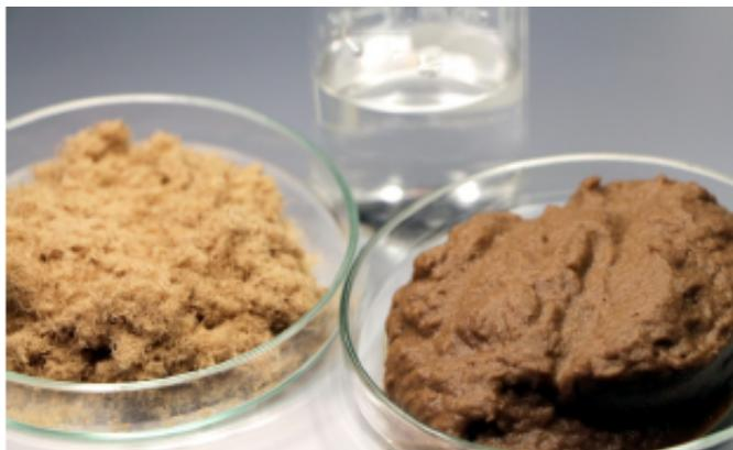
Die Ausgangsstoffe für den Holzschaum: Holzfasern und Wasser werden zu einer Suspension aufgemahlen und aufgeschäumt.
