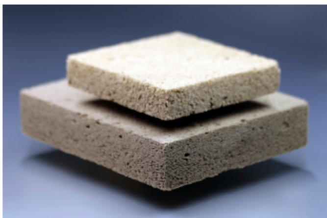
© Fraunhofer WKI Der am Fraunhofer WKI entwickelte Holzschaum besteht zu 100 Prozent aus nachwachsenden Rohstoffen.
