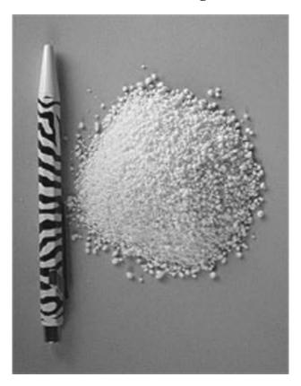
Ältere Bestandsimmobilien weisen oft eine mangelhafte Wärmedämmung an schwer zugänglichen Stellen auf. Das aus natürlichen, mineralischen Rohstoffen bestehende Blähglas-Granulat (Glas, Wasser und Zusatzstoffe als Füller werden miteinander vermischt und zu einem festen Granulat aufbereitet.
