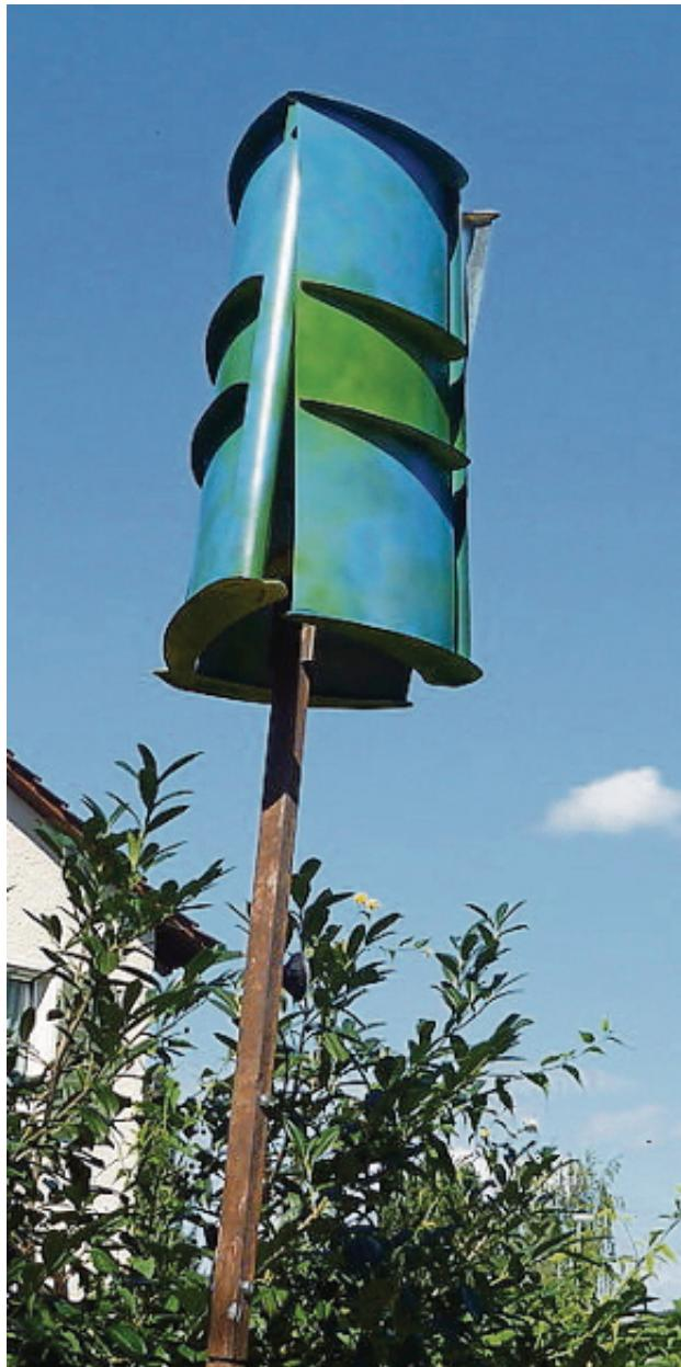
Der zusammenklappbare Windgenerator mit der maximalen Leistung von 1000 Watt bei 60 bis 100 Umdrehungen in der Minute ist das Produkt von jahrelangem Tüfteln und Ausprobieren. Was bei einem ersten Prototypen gelang, wird jetzt in der Konsequenz auf dem Hausdach des Einfamilienhauses umgesetzt. Für den Einsatz in Wohngebieten ist es notwendig, dass störender Lärm und unnötiger Schattenwurf ausgeschlossen ist und die Optik dem Umfeld weitgehend angepasst wird.
