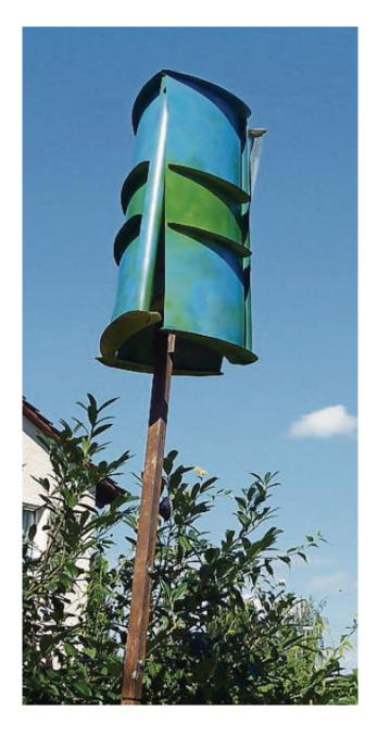
Der zusammenklappbare Windgenerator mit der maximalen Leistung von 1000 Watt bei 60 bis 100 Umdrehungen in der Minute ist das Produkt von jahrelangem Tüfteln und Ausprobieren. Was bei einem ersten Prototypen gelang, wird jetzt in der Konsequenz auf dem Hausdach des Einfamilienhauses umgesetzt. Für den Einsatz in Wohngebieten ist es notwendig, dass störender Lärm und unnötiger Schattenwurf ausgeschlossen ist und die Optik dem Umfeld weitgehend angepasst wird.
